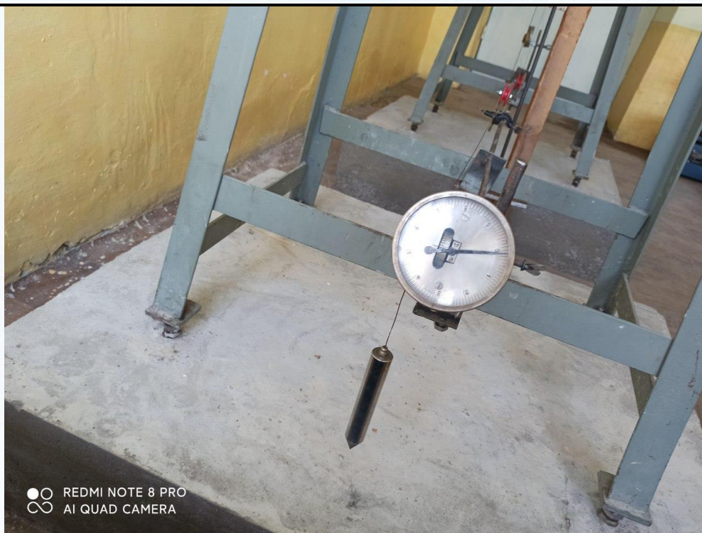
7-расм. панелни эгилишини ҳисоблаш учун ўрнатилган прогибомер
