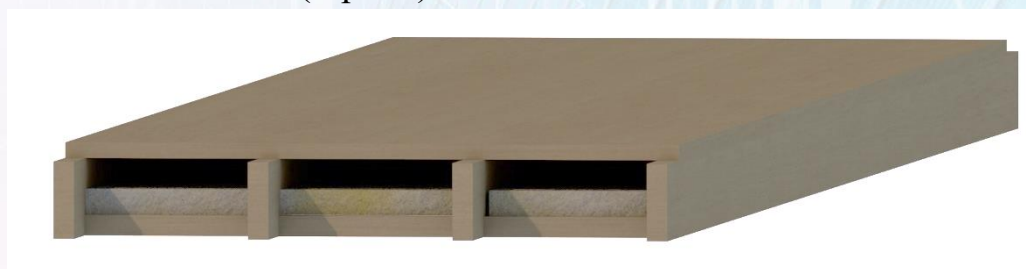
1-расм. Томёпма ва ораёпмалар учун инновацион енгил ва энергиятежамкор панел конструкциясининг умумий кўриниши.
